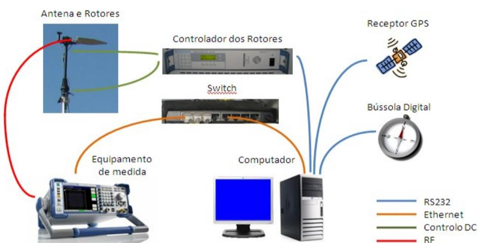
Nesta configuração de medida, inclui-se um analisador dedicado para DVB-T, da marca Rohde & Schwarz, modelo ETL, instalado na unidade móvel e ligado a uma antena log-periódica, da marca R&S, modelo HL040, para faixa de frequências: 400 –3600 MHz, em polarização horizontal, instalada num mastro hidráulico-pneumático, subido a uma altura de 10 m do solo.
