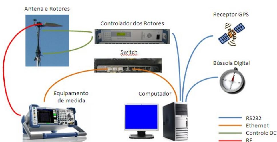
Nesta configuração de medida, inclui-se um analisador dedicado para DVB-T, da marca Rohde & Schwarz, modelo ETL, instalado na unidade móvel e ligado a uma antena log-periódica, da marca R&S, modelo HL040, para faixa de frequências: 400 –3600 MHz, em polarização horizontal, instalada num mastro hidráulico-pneumático, subido a uma altura de 10 m do solo.
