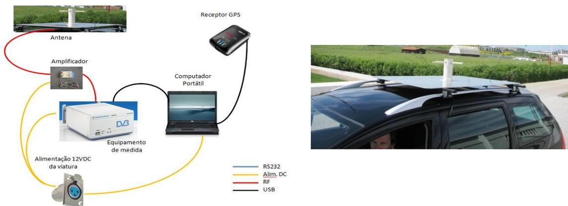
Na vertente imóvel de aquisição de dados a 10 m de altura, foi utilizada uma estação móvel de monitorização do espectro, assim como os diversos dispositivos auxiliares nela integrados.
