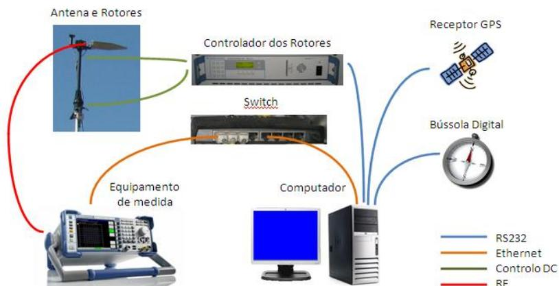
Nesta configuração de medição, inclui-se um analisador dedicado para DVB-T, da marca Rohde & Schwarz, modelo ETL, instalado na unidade móvel e ligado a uma antena log-periódica, da marca R&S, modelo HL040, para faixa de frequências: 400 – 3600 MHz, em polarização horizontal, instalada num mastro hidráulico-pneumático, subido a uma altura de 10 m do solo.
